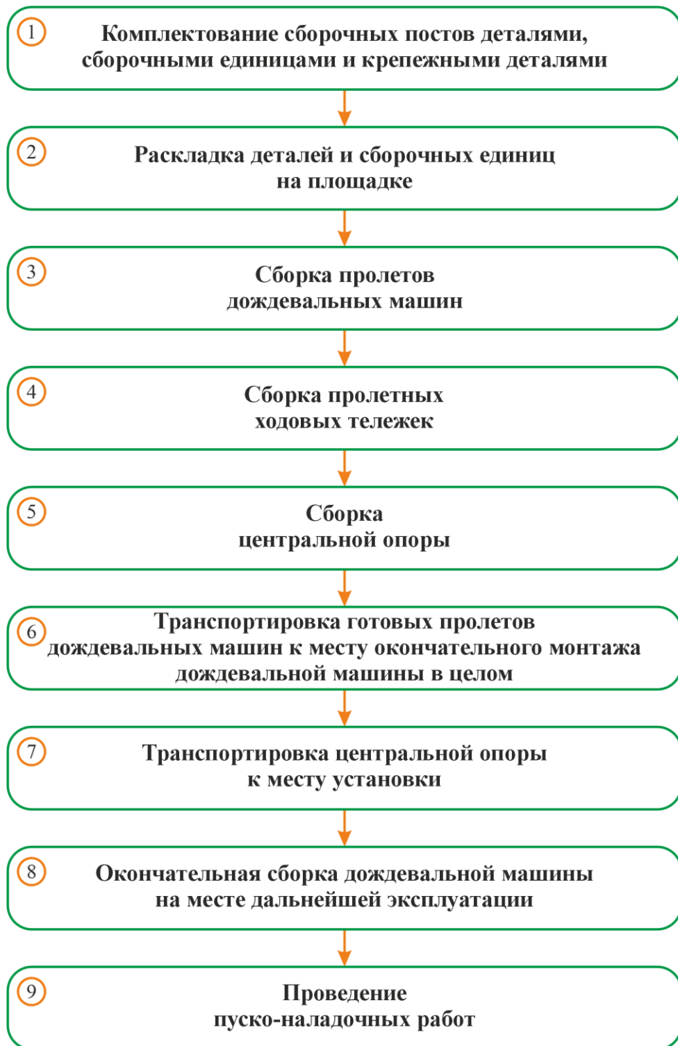
Рисунок 2.10 – Технология подготовки к эксплуатации дождевальной машины кругового действия ДМ «Каскад»
