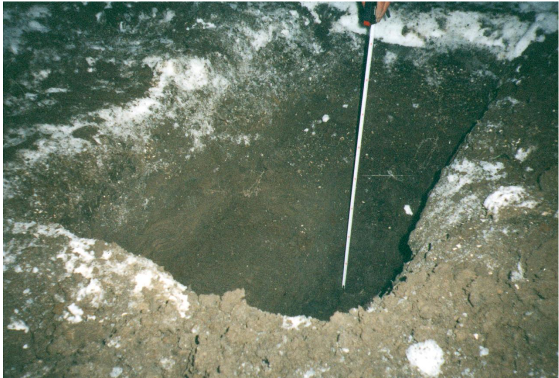
Рисунок 3.5 – Замер толщины отложений в русле канала
